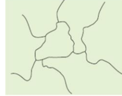
(d) Dark lines are grain boundaries
